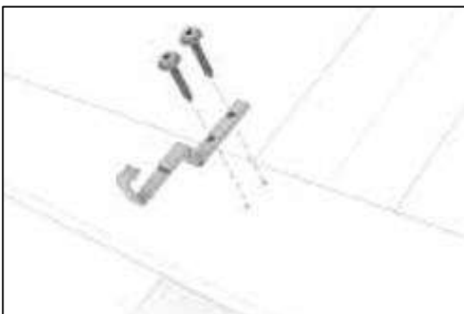
Figura 4-5 fissaggio staffe di montaggio telaio
